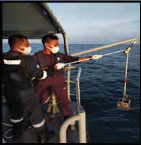
Kerja-kerja Pengumpulan Sampel Dasar Laut Dengan Menggunakan Ponar Grabner
