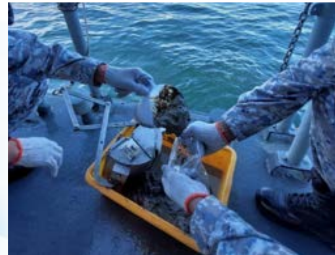
Kerja-kerja pengumpulan sampel dasar laut dengan menggunakan Ponar Grabner
